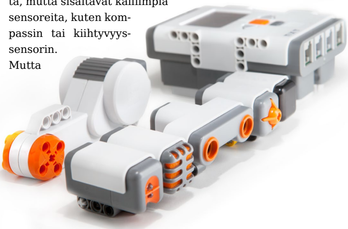
LEGO Mindstorms NXT -sarjan moottori, valo- ja äänisensori, ultraäänietäisyysmittari, kosketus- ja kiihtyvyyssensori sekä ohjainyksikkö
